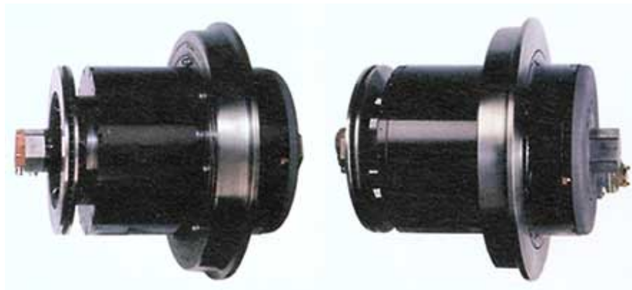
Рис. 2. Общий вид ступичного привода с тормозным диском
